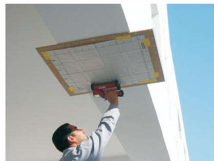
Rétablissement du ferrillage par un scanneur approprié
